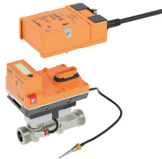
Abb. 47: Die gesamte Verdrahtung ist mit dem Logikmodul verbunden, sodass das Sensormodul EN 1434/MID neu kalibriert werden kann, ohne die Verdrahtung zu lösen.
